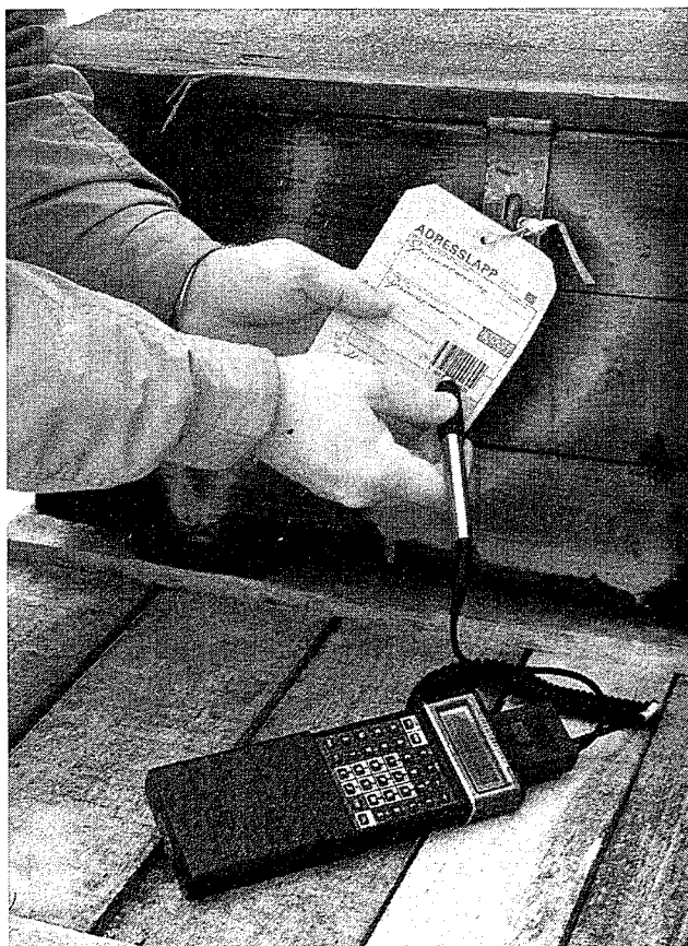
Streckkod på mottaget material avläses på arbetsplatsen
